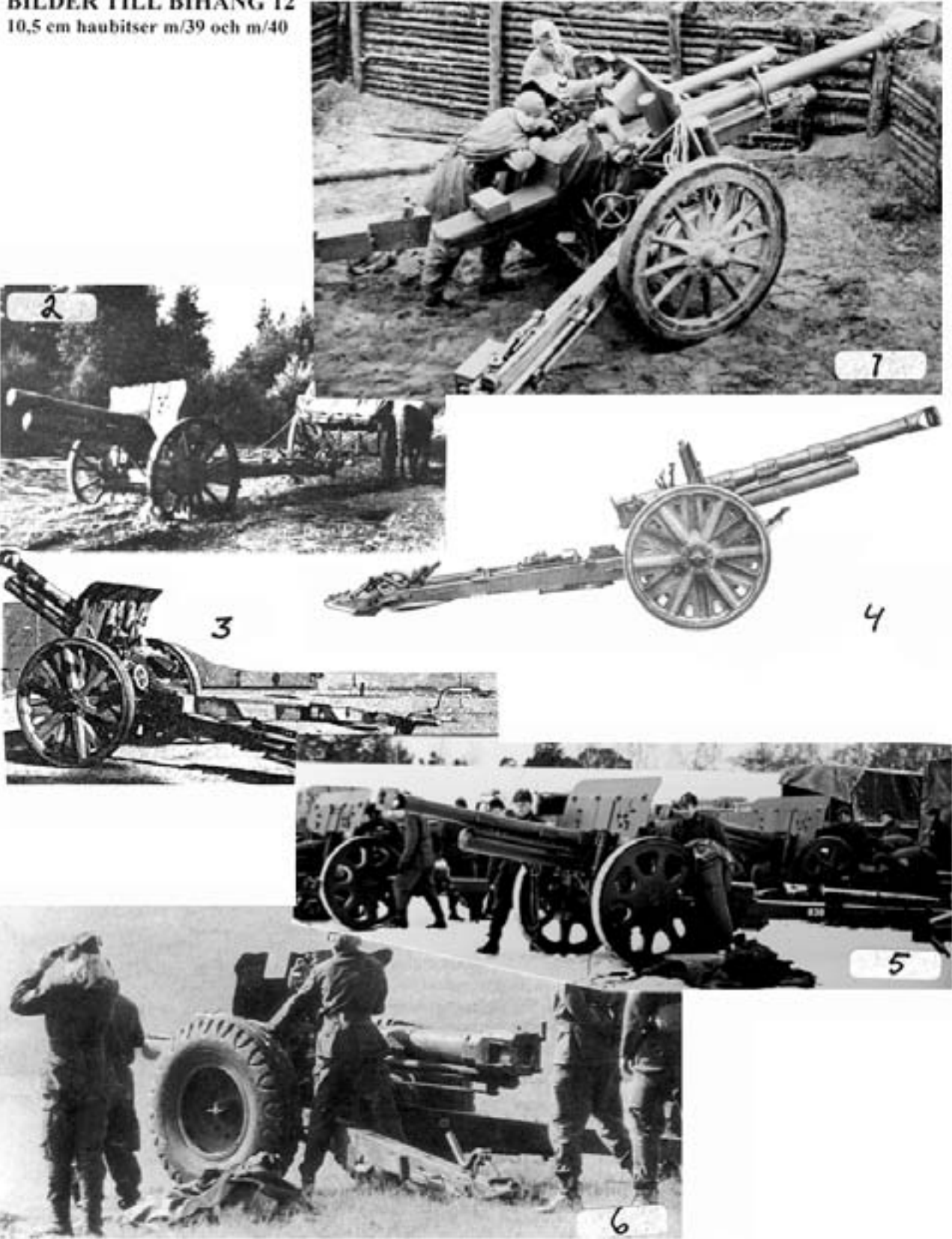
Bild nr 1, m/39 med mynningsbroms och tråhjul som tålde dragning efter motorfordon. Nr 2, en ursprunglig m/40 med korta eldröret och tråhjul för hästdragning. Nr 3, en ovanlig bild från ca 1950 med mynningsbroms på kort eldrör, vilken aldrig kom ut och lättmetallhjul m/40 som efterhand hade ersatt tråhjulen. Nr 4, en m/40 med långa eldröret och mynningsbroms. Nr 5 en m/40C med rak sköld och stålhjul. Nr 6, en m/40 med gummihjul (för alla m/40 utom H).
