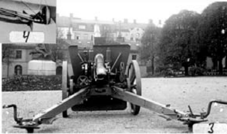
Bild 1 visar ursprungsmodellen grupperad med ammunitionsbakvagnen bredvid, båda med sköld. Nr 2, visar en m/02-10 där kanonen lagts i överblivna m/10-lavetter med hål i hetsvanslavetten för att medge högre elevation. Bild 3 visar m/02-33 där kanonen försetts med ny V-lavett. Bild 4 visar värnkanon m/02-51 där överlavetten flyttats till en specialunderlavett för låga värn.
